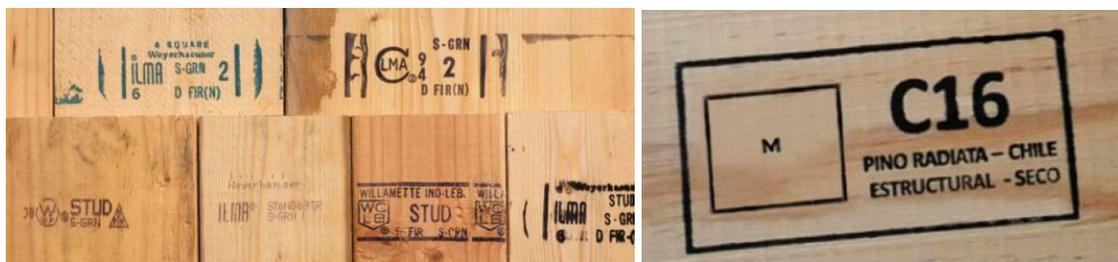
Figura 6 Ejemplos de rotulados de madera (Smulski, 1996) y Prototipo rotulado INFOR (MINVU, 2018b)
